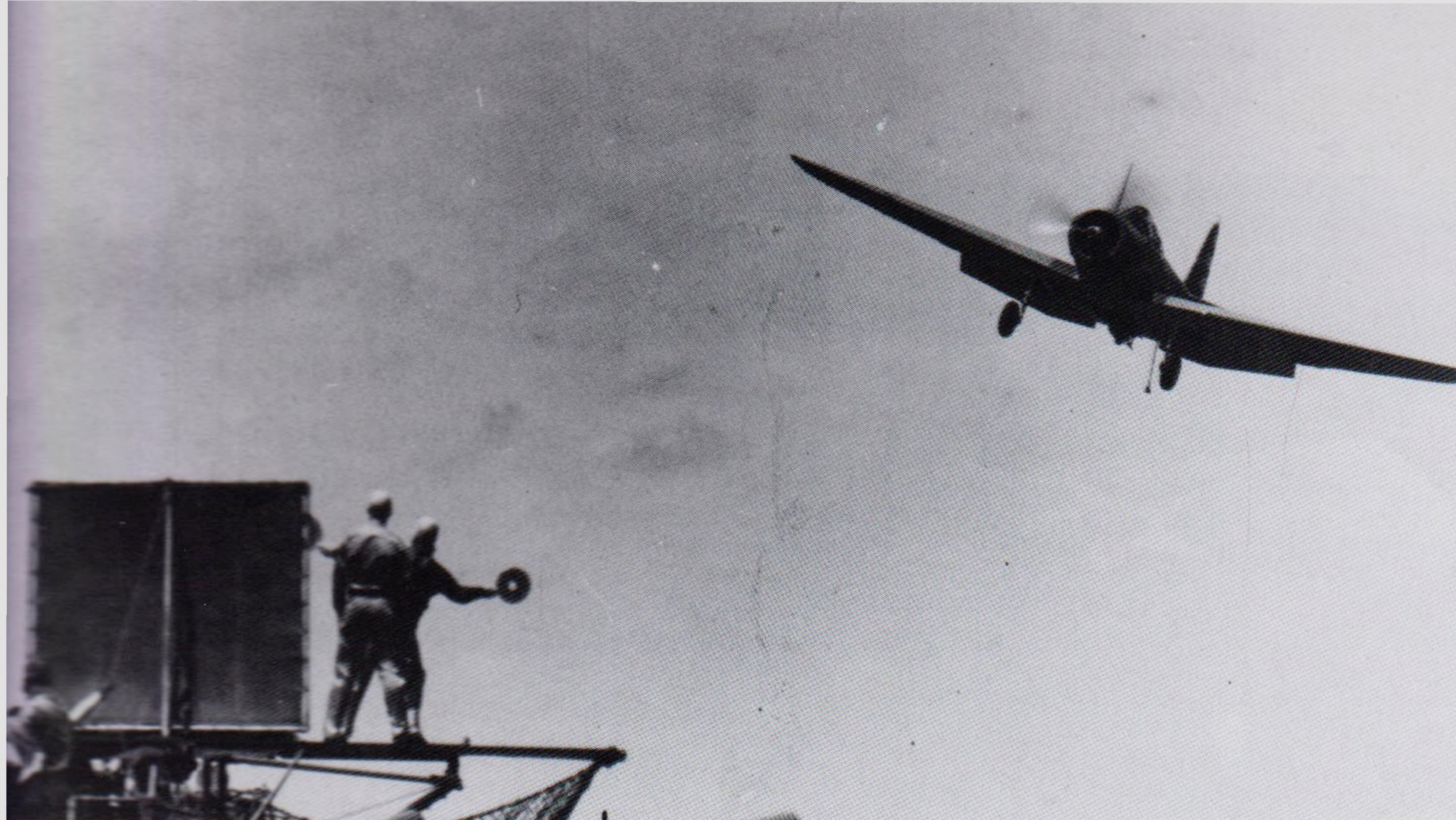
Douglas TBD-1 squadrony VT-6 se přibližuje k přistání palubu letadlové lodě USS Enterprise, 4. květen 1942. Patrný je vyklopený přistávací hák pod zadní částí křídla.
