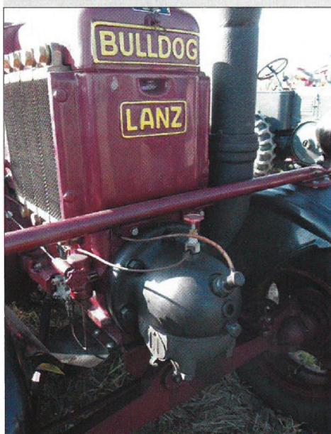
Lanz Bulldog se startoval letlampou, která musela nažhat hlavu válce doruda, pak řidič sňal volant, nasadil z boku na hřídel a motor roztočil, až se rozběhl... str. 55
