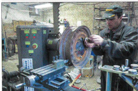
Rovnění ráfků u firmy MotoReno... str. 30
