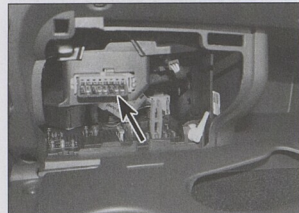
2.2 Diagnostický konektor (šipka) je umístěn nad pojistkovou skříň v kabině vozidla
