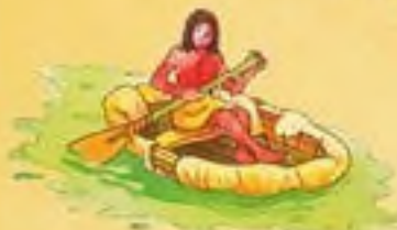
Člun ze zvířecí kůže napjaté přes dřevěnou kostru.
